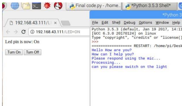
Fig.10 - Controlling NodeMCU (Switch ON)
